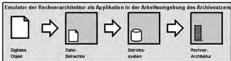
Abbildung 3: Das Beispiel zeigt einen generellen View-Path zum Rendering/ Ablaufenlassen eines digitalen Objekts eines bestimmten Typs unter Einsatz der Emulationsstrategie.
